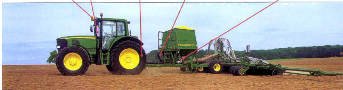
CAN-Bus propojení mezi traktorem a přívěsem (ISO 11783)
